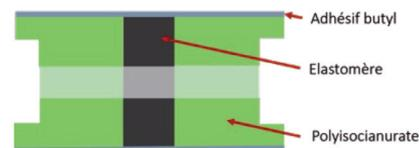
En régime froid, le tuyau et l'isolant se **contractent** dans des amplitudes différentes, l'isolant **tire** sur les arrêts d'isolation et les adhésifs, ce qui occasionne un risque de rupture de la continuité du pare-vapeur
