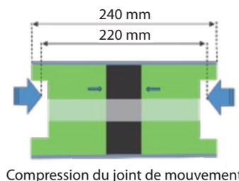
En régime froid, L'ISOPIRFLEX vient absorber la **contraction** des isolants au niveau des arrêts d'isolation et des adhésifs par élancement de l'élastomère.
