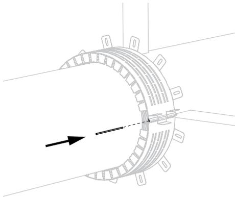
3. Fermez le manchon à l'aide du dispositif de fermeture. Glissez ensuite l'axe fourni à travers les charnières et repliez la languette protectrice.
