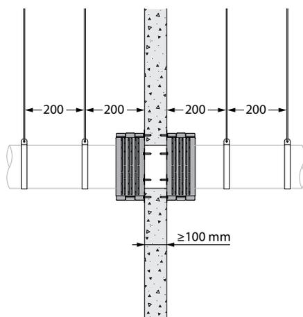
7. Le tuyau doit être supporté afin de pouvoir garantir le bon fonctionnement du colmatage lors d'un incendie. Les supports et fixations seront réalisés suivant les règles de l'art.
