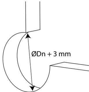
1. Prévoyez une ouverture  $\varnothing D_n + 3 \text{ mm}$ .
