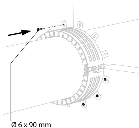
4. Utilisez des vis standard  $\varnothing 6 \times 90 \text{ mm}$  pour fixer le manchon à la paroi/dalle.
