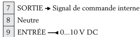
Les bornes 7 et 9 sont shuntées d'origine. Enlever le shunt pour pouvoir utiliser la fonction de signal externe.
