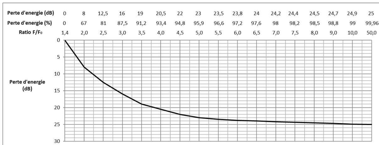
\*Pour connaître l'atténuation, il faut calculer le ratio  $F/F_0$  qui correspond à la fréquence excitatrice  $F$  (nombre de tours de la machine, fréquence des moteurs, etc...) divisée par la fréquence propre  $F_0$  (dépendante de la charge appliquée au produit)
