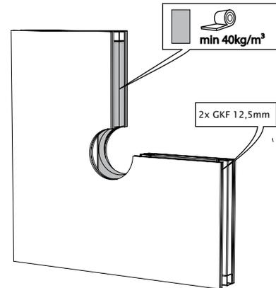
2. Isolez la paroi entre les profils métalliques et complétez avec deux plaques de plâtre GKF.
