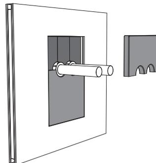
6. Fixez le second panneau de laine de roche de min. 50 mm d'épaisseur autour du manchon. Veillez à ce que les joints des deux couches soient décalés. Enduisez la tranche des panneaux et les joints d'enduit coupe-feu (type PROMASTOP-E).
