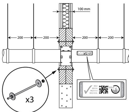
7. Installez 3 tiges filetées à travers les panneaux de laine de roche et fixez les à l'aide de rondelles et d'écrous M6. Collez l'étiquette près du manchon.
