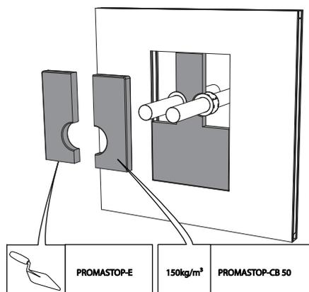
5. Fixez un panneau de laine de roche d'épaisseur 50 mm recouverte d'enduit coupe-feu sur une face (type PROMASTOP-CB 50) autour du manchon. Utilisez une scie ou un cutter pour découper le panneau aux bonnes dimensions. Enduisez la tranche des panneaux et les joints d'enduit coupe-feu (type PROMASTOP-E).
