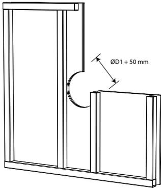
1. Fixez deux plaques de plâtre type GKF d'épaisseur 12,5 mm d'un côté de la paroi.
