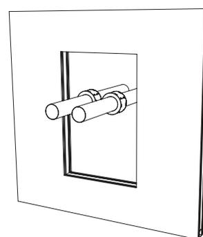
4. Enlevez l'étiquette, ouvrez le manchon et placez-le autour du tuyau. Insérez les languettes de fermeture dans les ouvertures prévues et pliez-les. Centrez le manchon dans l'épaisseur de la paroi.
