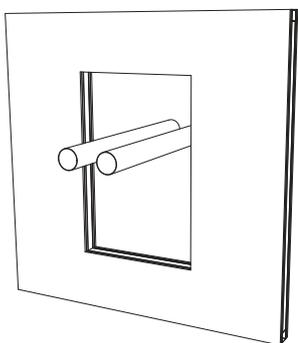
3. Placez le(s) tuyau(x). La distance minimale entre deux tuyaux et entre un tuyau et le bord de la réservation est de 100 mm.
