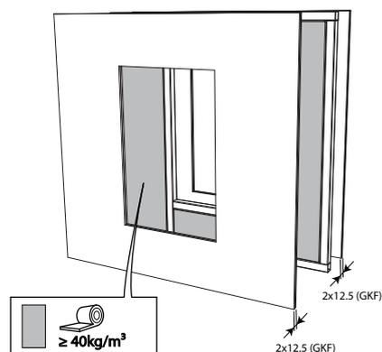
2. Fixez deux plaques de plâtre type GKF d'épaisseur 12,5 mm d'un côté de la paroi. Isolez la paroi entre les profils étalliques (laine minérale 40 mm, 40 kg/m<sup>3</sup>) et complétez avec deux plaques de plâtre GKF.
