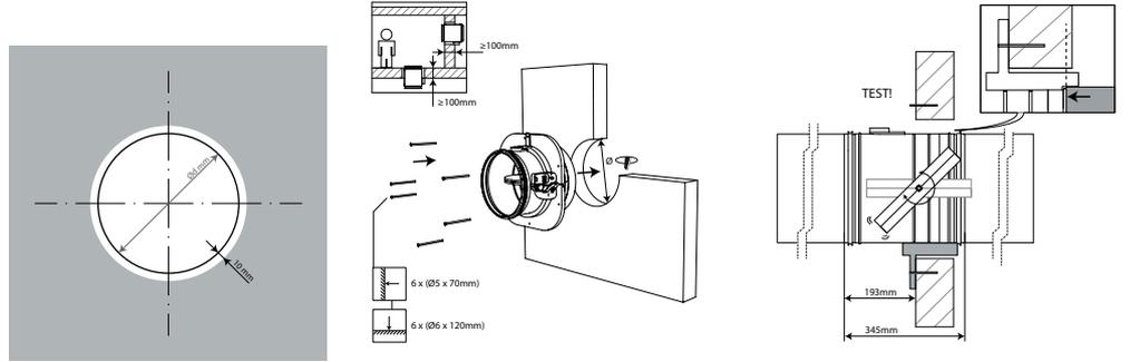
Soumettre le clapet à un test.
