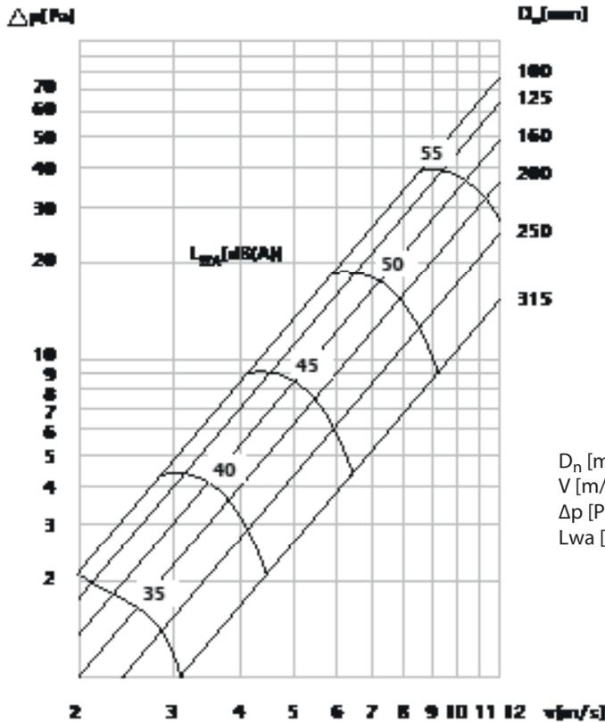
$D_n$  [mm] = Diamètre nominal du clapet
