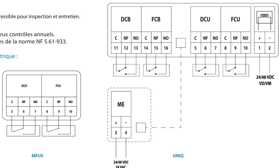
Nous attirons votre attention sur le fait que les moteurs de réarmement du mécanisme UNIQ fonctionnent en 24V AC (courant alternatif) et DC (courant continu), et en 48V uniquement en DC.
