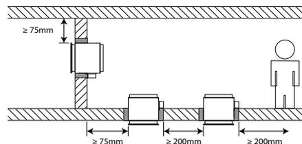
Le clapet doit être accessible pour inspection et entretien.
