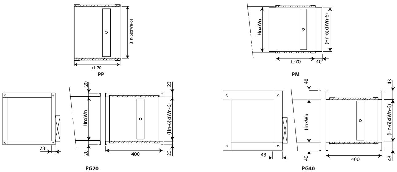
Le clapet CU2-L est un clapet CU2 dont le tunnel a été allongé d'un ou des deux côtés :
