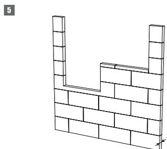
5. Prévoyez dans la paroi les réservations nécessaires  $(L_n + 100 \text{ mm}) \times (H_n + 100 \text{ mm})$ .
