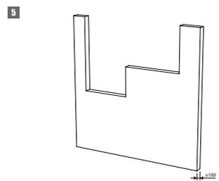
5. Prévoyez dans la paroi les réservations nécessaires ( $(L_n + 100 \text{ mm}) \times (H_n + 100 \text{ mm})$ ).
