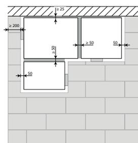
Les unités peuvent être installées à distance minimale d'une plafond ( $\geq 25$  mm), d'une paroi ou d'un autre clapet
