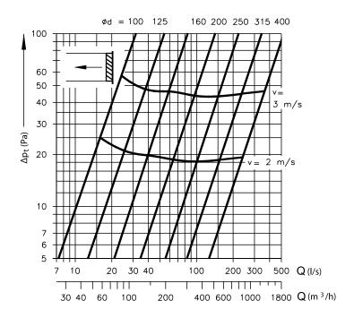
$Q = D\acute{e}bit d'air en l/s et m^3/h - \Delta Pt = Perte de charge totale en Pa - v = Vitesse d'air moyenne dans la gaine en m/s$ Ød = Modèle de la grille
