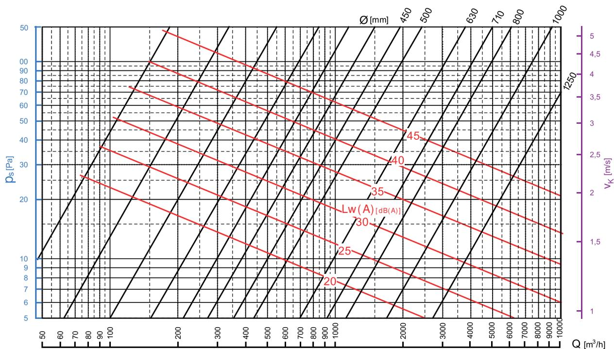
Ps = Perte de charge en Pa – Q = Débit d'air en m³/h – Vk = Vitesse effective en m/s – Ak = Surface effective en m²
